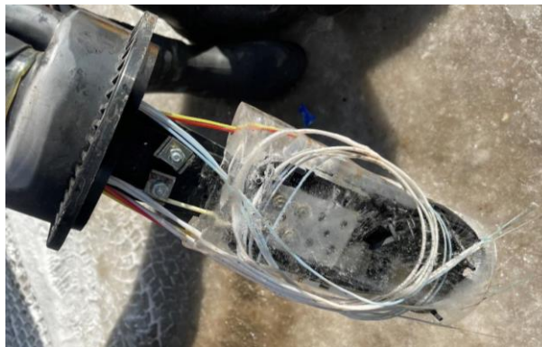
Рис. 5. Скопившаяся замерзшая вода в муфте. Видна обломанная часть волокон
