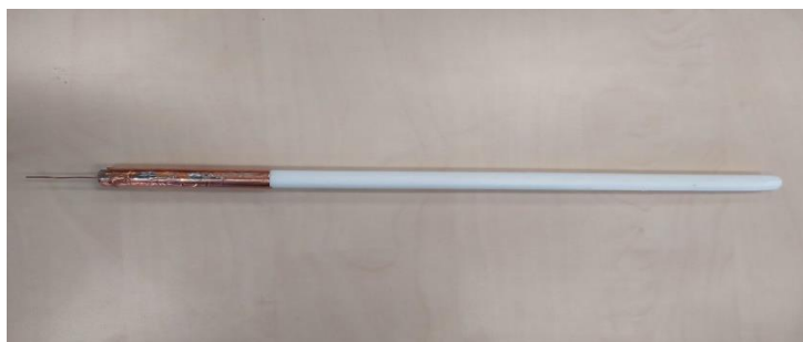
Рис. 2. Синтезированный макет диэлектрической стержневой антенны с коаксиальным питанием
