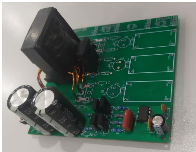
Рис. 5. Собранный преобразователь без выходных фильтров
