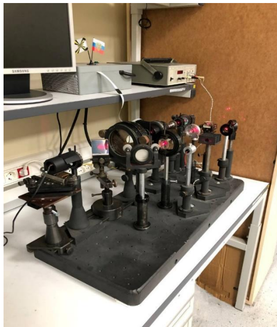
Рис.3. Фото экспериментальной установки для электронной записи и оптического восстановления голограмм
